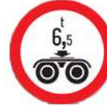
Accesul interzis vehiculelor cu masa pe osie dubla mai mare de X t
